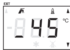
Fig. Actual water temperature
